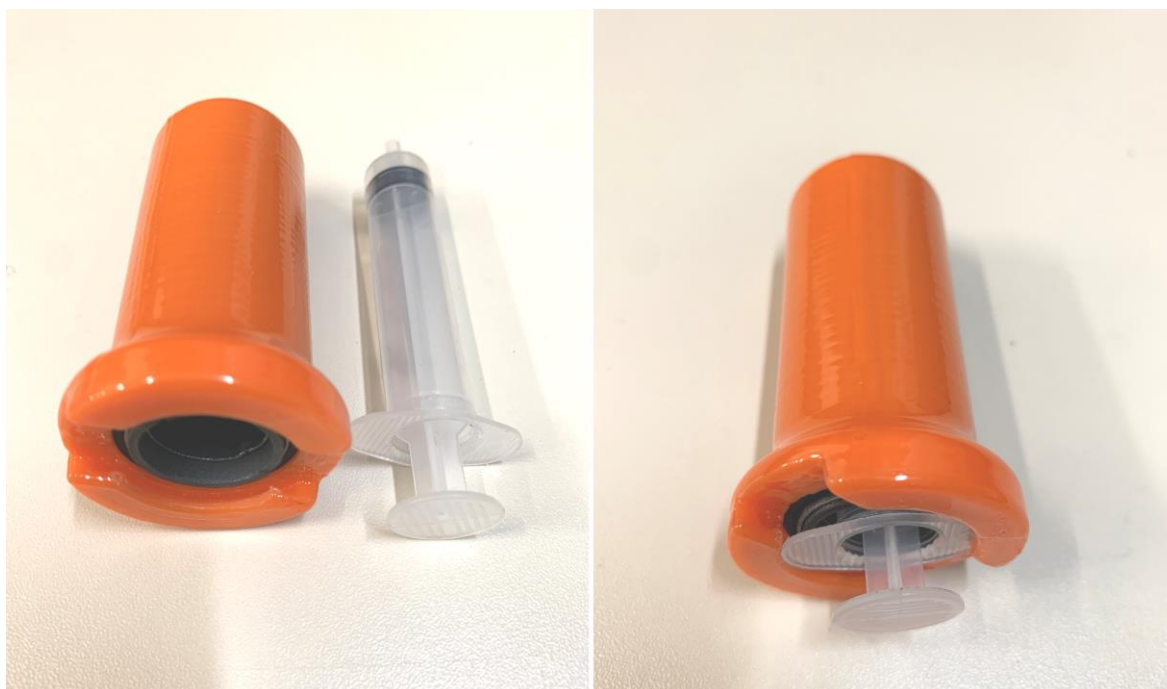
Figura 21: Protetor de seringa confeccionado em impressora 3D
