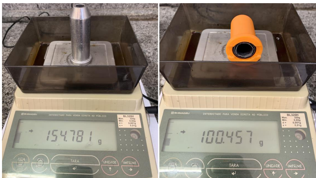
Figura 22: Comparativo de peso de um protetor de seringa comercial X protetor impressão 3D
