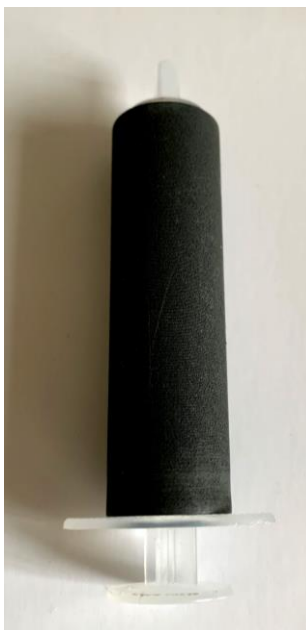
Figura 16: Aplicação do cilindro de W na seringa de 5 ml
