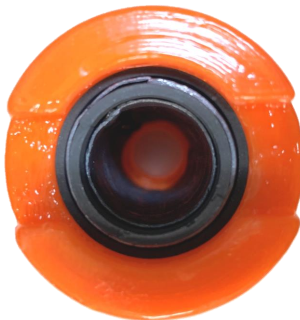
Figura 19: Camadas do protetor do centro para fora (Pb+W+Pb+W+ABS) com atenuação de 92,69%
