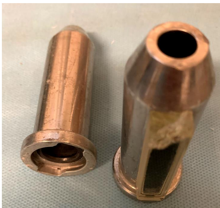
Figura 17: Protetor de seringa de chumbo revestido com aço inox e visor
