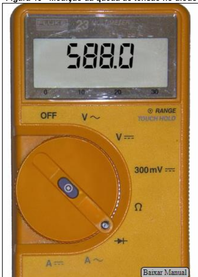
Figura 40 - Medição da queda de tensão no diodo
