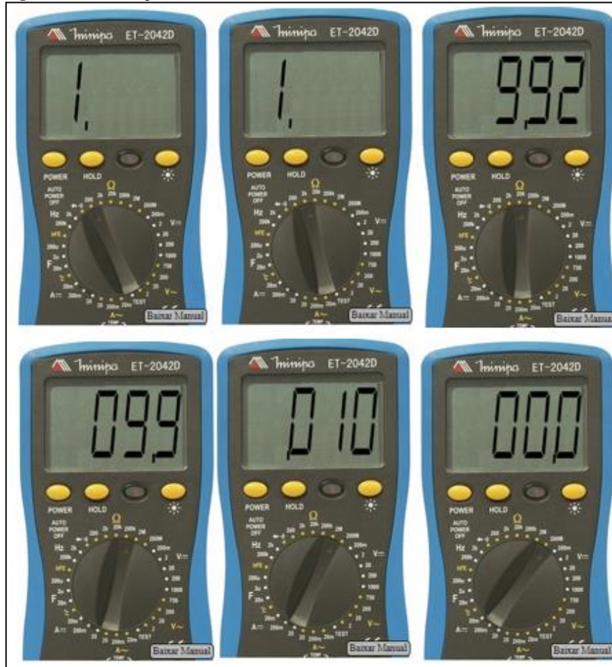
Figura 45 - Medição de resistor de 10K \Omega em diferentes escalas – VISIR
