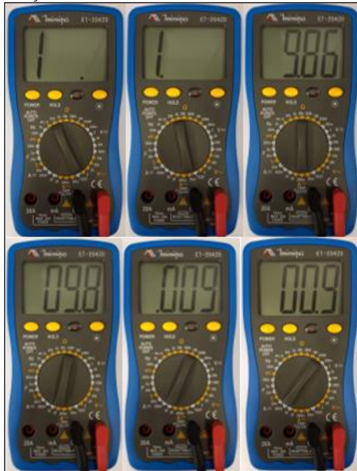
Figura 46 - Medição de resistor de 10k \Omega em diferentes escalas – instrumento real
