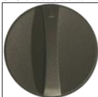
Figura 43 - Chave seletora do multímetro
