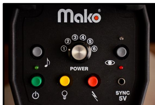
Figura 49: Flash com a regulação da potência na posição 1 que é a mais fraca
