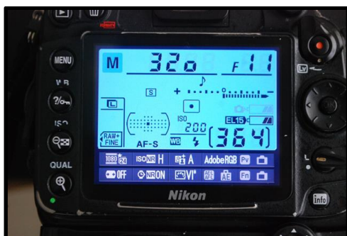
Figura 48: LCD da câmera com a calibragem da velocidade do obturador em 1/320, WB em Flash e ISO em 200.
