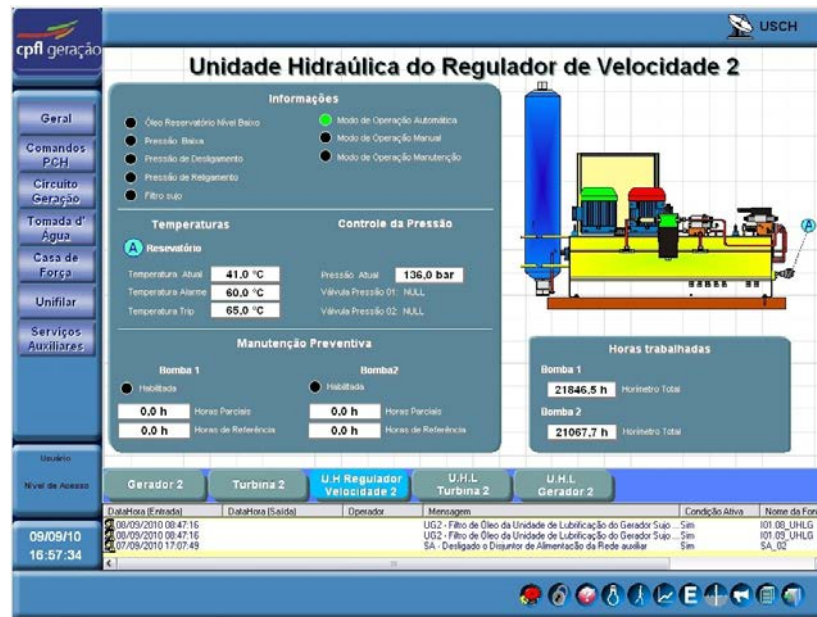
Figura 50 - Controle da Unidade Hidráulica
