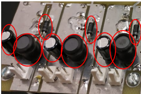
Figura 79 – Foto da placa antes das alterações dos componentes dos circuitos buck
