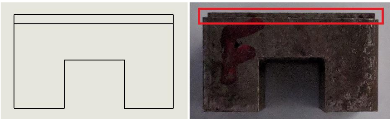
Figura 34: Erro visível causado por diferença de distância entre a câmera e o objeto.
