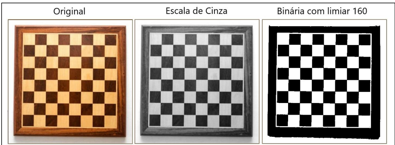
Figura 15: Conversão para escala de cinza seguida de binarização
