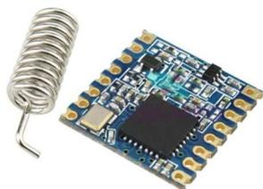
Figura 15 - Transceptor SX-1276. Semtech. Fonte: o Autor.
