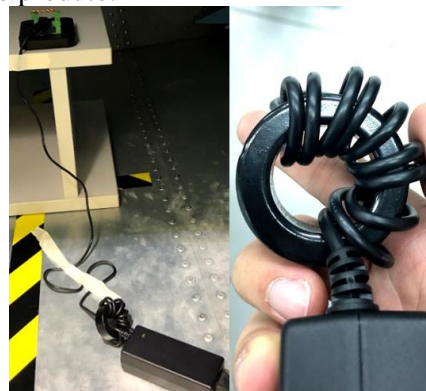
Figura 24 - Fio enrolado em núcleo toroidal. Fonte: Autoria própria.
