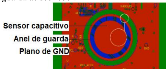
Figura 18 - Sensor capacitivo projetado. Fonte: Autoria própria.
