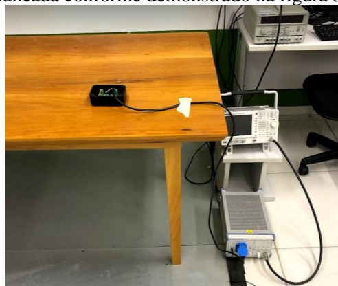
Figura 35: Ensaio de emissão conduzida sem conversor de energia.
