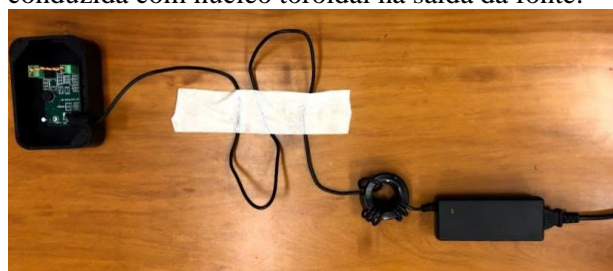
Figura 25 - Ensaio de emissão conduzida com núcleo toroidal na saída da fonte. Fonte: Autoria própria.
