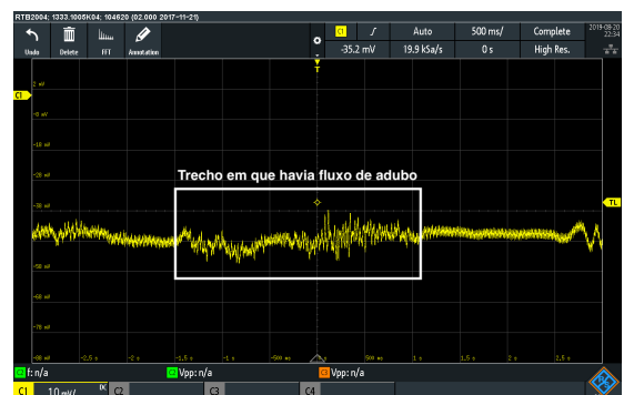
Figura 11: Saída do transdutor radar no momento em que houve fluxo de adubo.
