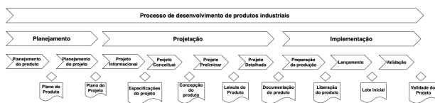
Figura 1: Fases de planejamento e projeção. Fonte: Adaptado de BACK et al., 2008
