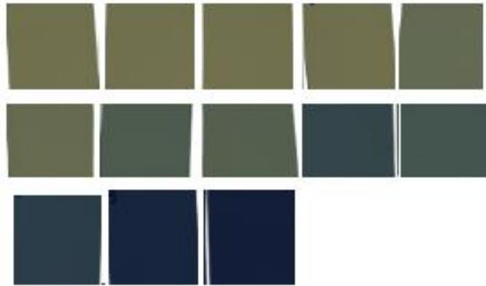
Figura 26 - Demonstração do enegrecimento da curva de calibração dos filmes radiocrômicos
