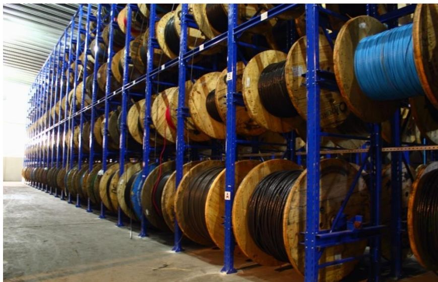
Figura 2 – Exemplo de estoque de produtos acabados em forma de prateleira porta bobinas de madeira.
