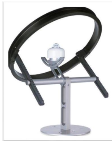
Figura 19 - Piranômetro com banda de sombreamento
