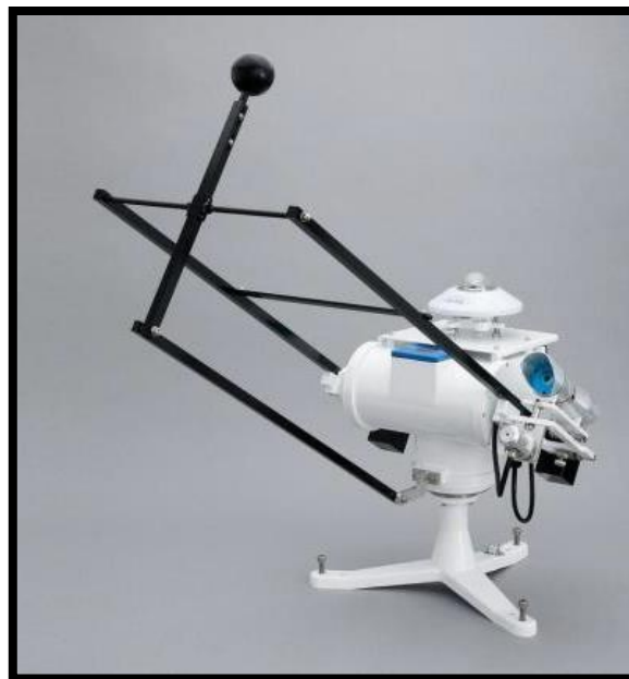
Figura 20 - Piranômetro com esfera de sombreamento de dois eixos
