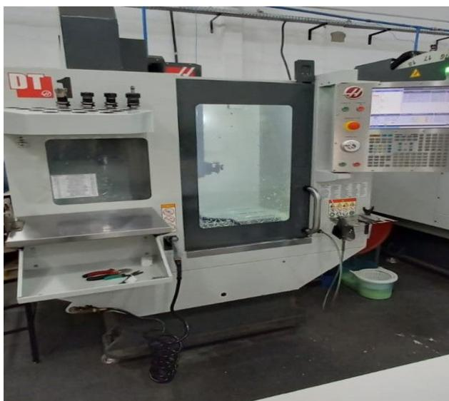
Figura 3: Máquina CNC *Hass Mill Dt1*. Fonte: Os autores.
