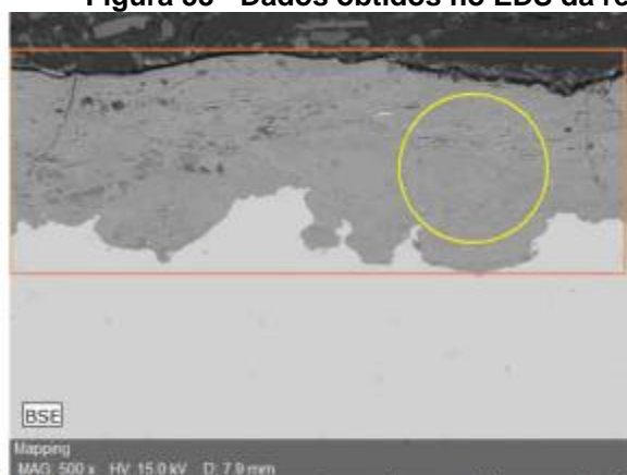
Figura 10a – Região de microanálise química semiquantitativa. Aumento 500x.
