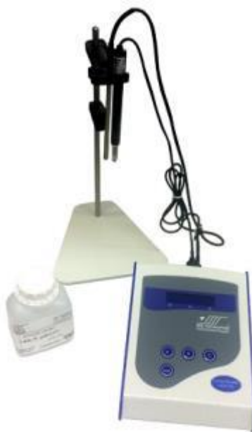
Figura 31 – Condutivímetro de bancada MCA-150 Tecnocon
