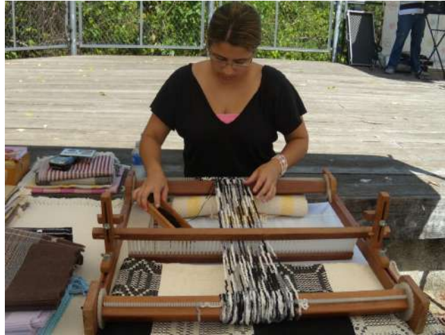
Figura 04 - Tear Manual de Pente Liço
