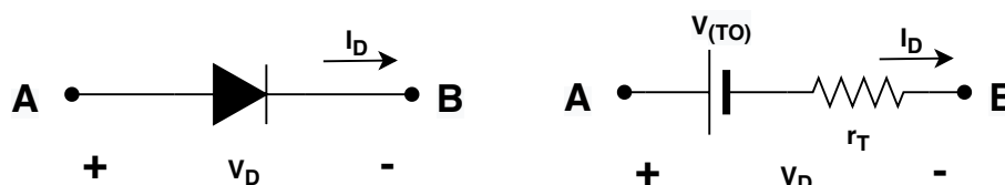
Figura 9 – Representação da queda de tensão do diodo real e sua resistência interna
