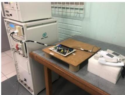
**Figura 34 – Setup teste BURST**
