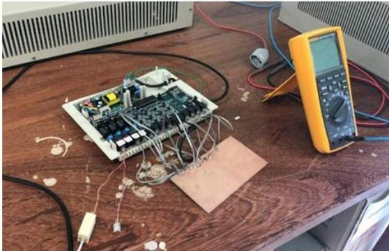
**Figura 35 – Setup teste Proteção contra Choque elétrico**
