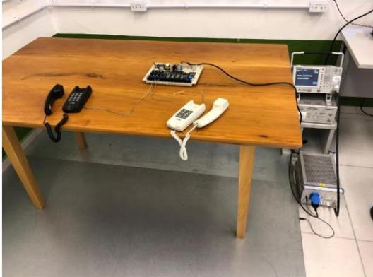
**Figura 21 – Setup Teste Emissão Conduzida realizado no IFSC**
