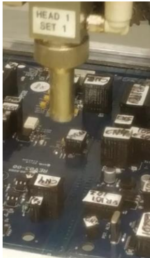
Figura 11 - Peças plásticas protegendo conectores durante aplicação
