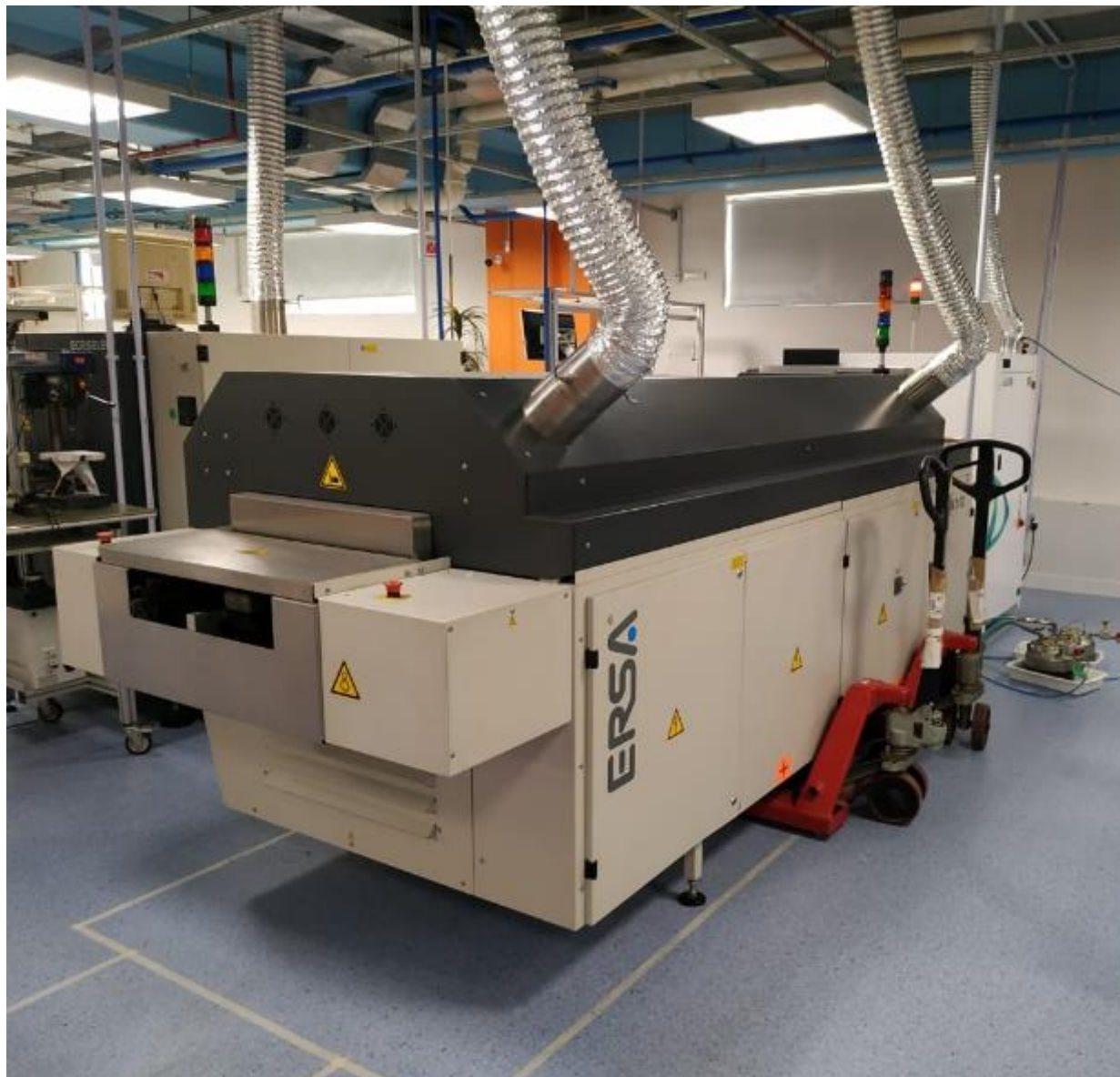
Figura 28 - Posicionamento do forno seguindo as demarcações
