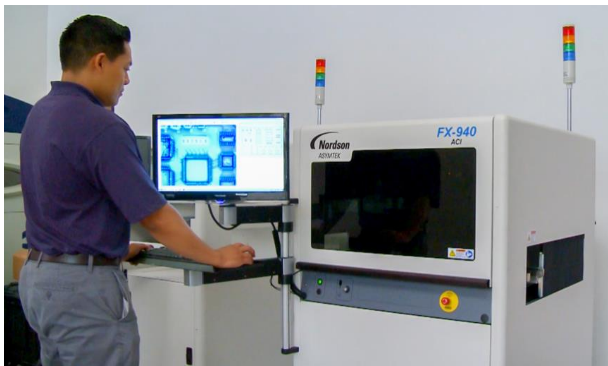
Figura 10 - Inspeção automatizada de aplicação de verniz
