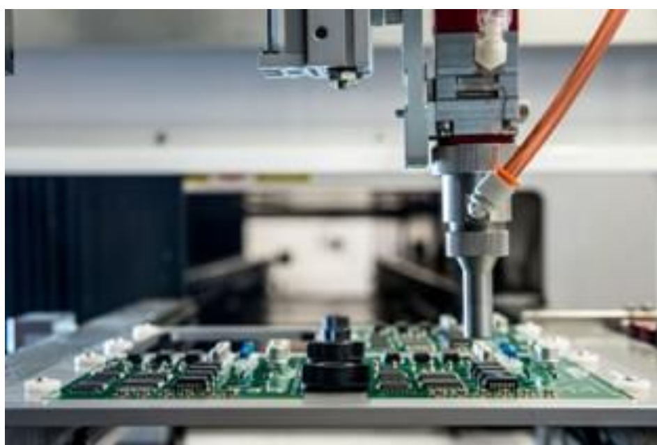
Figura 6 - Aplicação seletiva de revestimento
