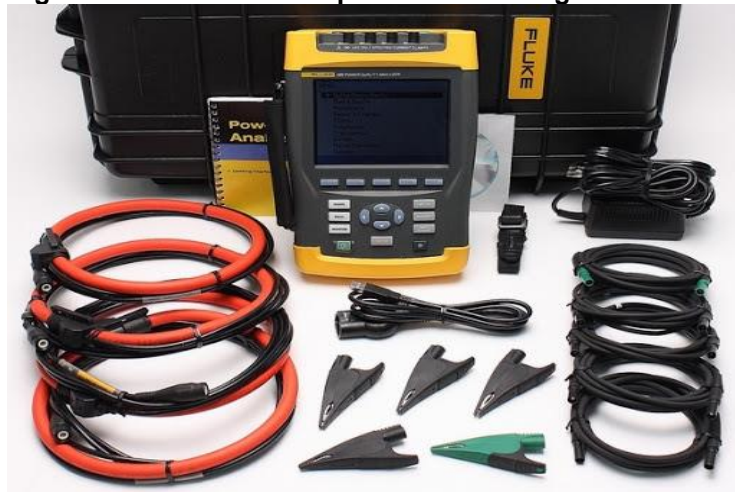
Figura 9 – Analisador de qualidade de energia FLUKE 435
