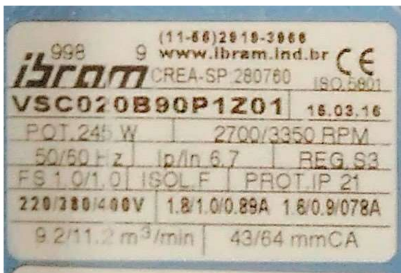
Figura 8 – Placa de identificação do ventilador.
