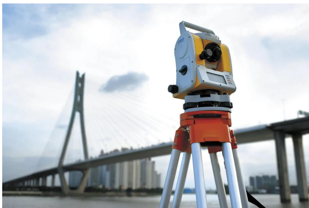
Figura 16 - Estação total em posição
