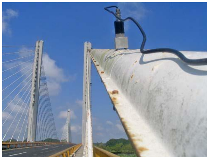
Figura 20 - Acelerômetro fixado à ponte
