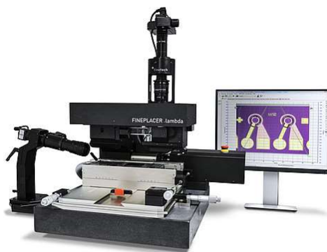
Figura 13 - Imagem do equipamento Fineplacer utilizado na realização dos experimentos de interligação dos chips e substratos
