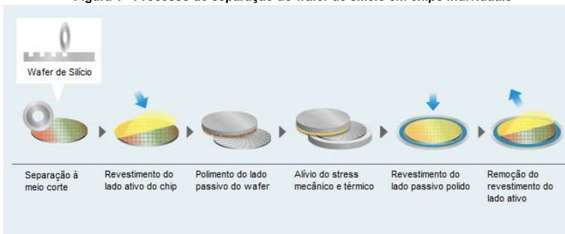
Figura 1 - Processo de separação do wafer de silício em chips individuais
