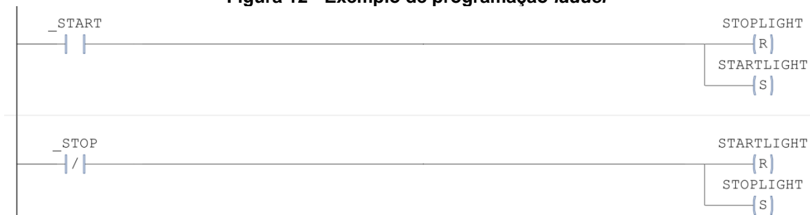
Figura 12 - Exemplo de programação ladder
