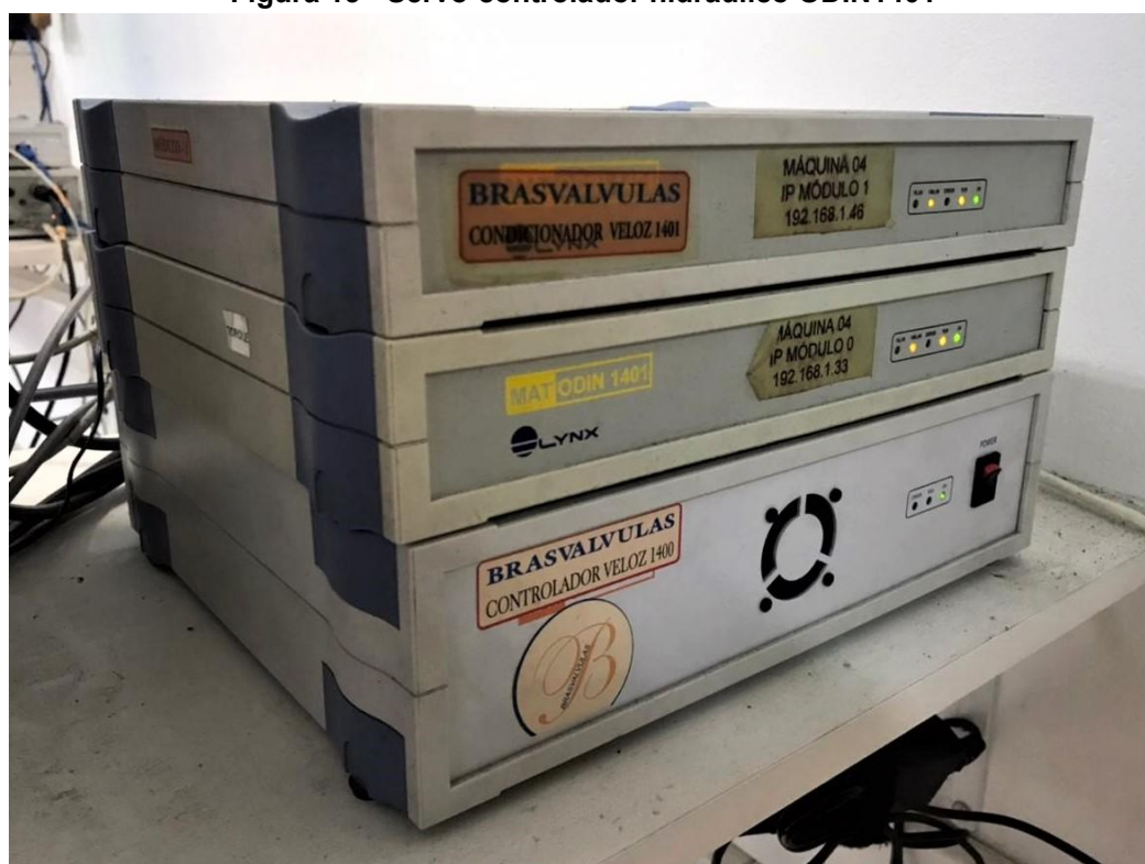
Figura 13 - Servo-controlador hidráulico ODIN1401
