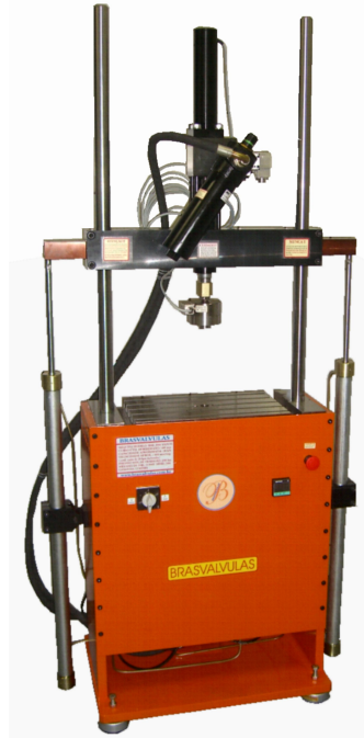
Figura 9 - Máquina servo-hidráulica Brasválvulas
