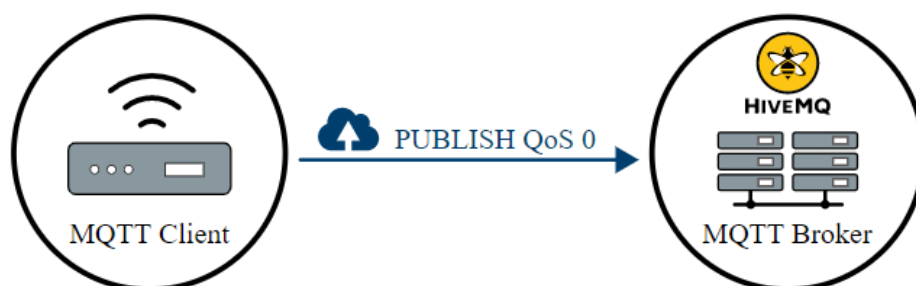
Figura 7 - Representação do envio de um pacote MQTT com QoS 0
