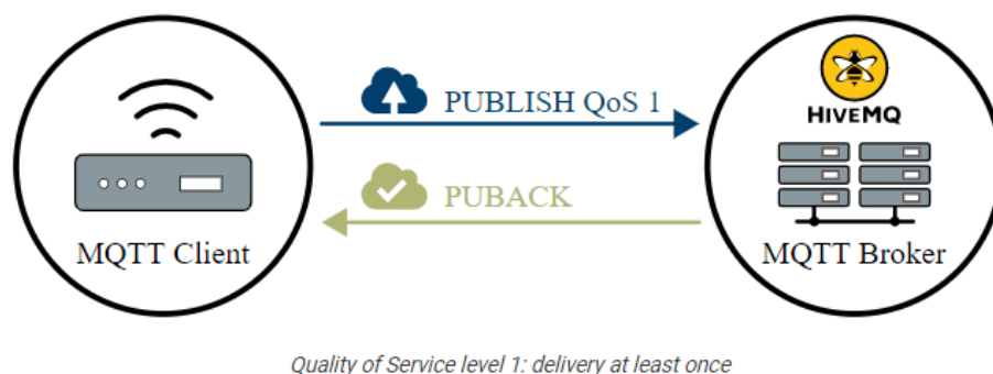
Figura 8 - Representação do envio de um pacote MQTT com QoS 1
