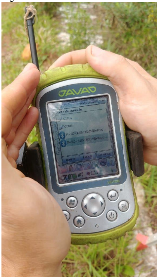
Figura 10: Conexão bluetooth entre coletora e receptoras.
