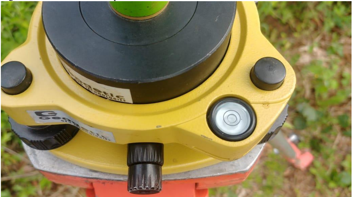
Figura 9: Nivelamento da receptora base.
