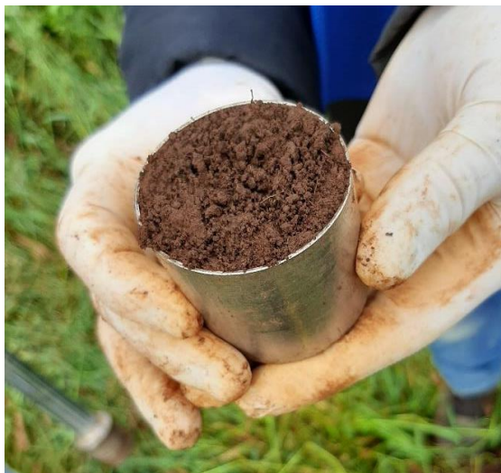
Figura 2 - Anel coletor de 5 cm de altura e 7 cm de diâmetro para análise física do solo.
