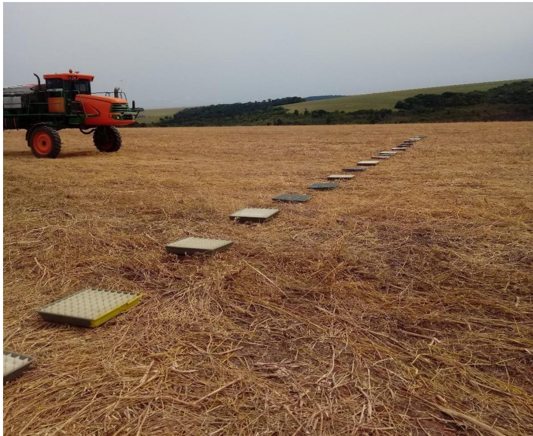
Figura 1 – Aferição e regulagem de distribuidor autopropelido de insumos a campo.
