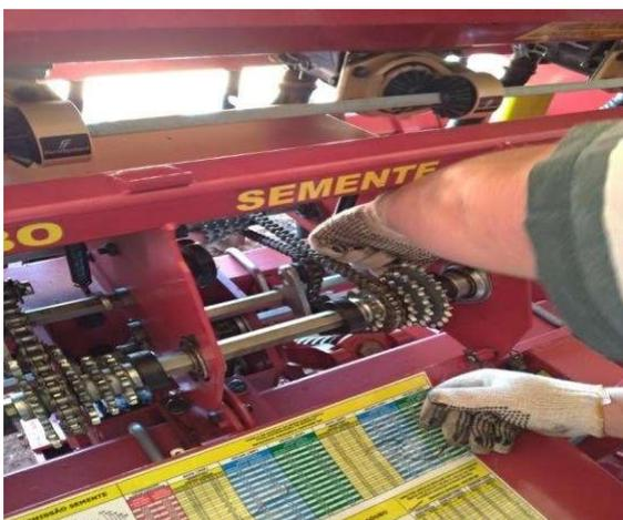
FIGURA 4 - Regulagem da semeadora para utilização em lavoura de soja – Pranchita (PR).
