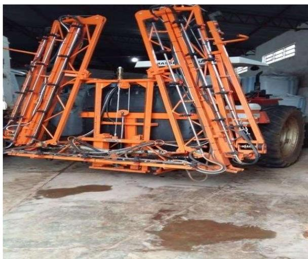
FIGURA 7 – Pulverizador de barra com capacidade de 600L.
