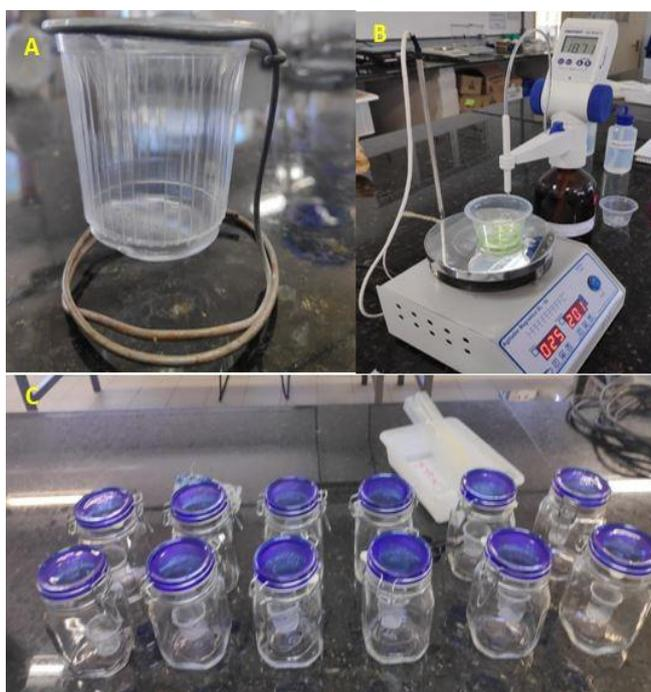
FIGURA 1 - A- Recipiente contendo ácido bórico para captura de de N- $\text{NH}_3$ ; B- Titulação das amostras; C- Frascos herméticos usados no estudo.
