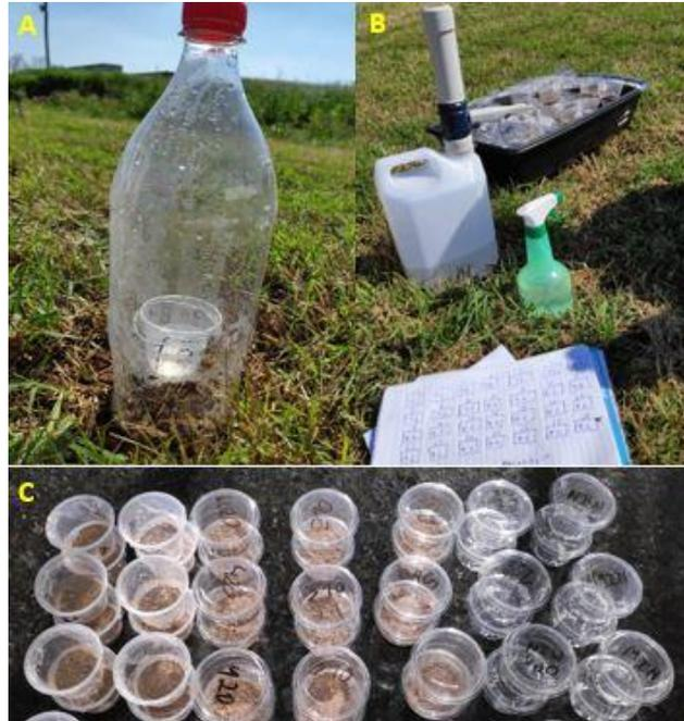
FIGURA 3 - A - Câmera coletora de amônia construída com garrafas PET; B e C - Materiais usados na aplicação dos tratamentos a campo.
