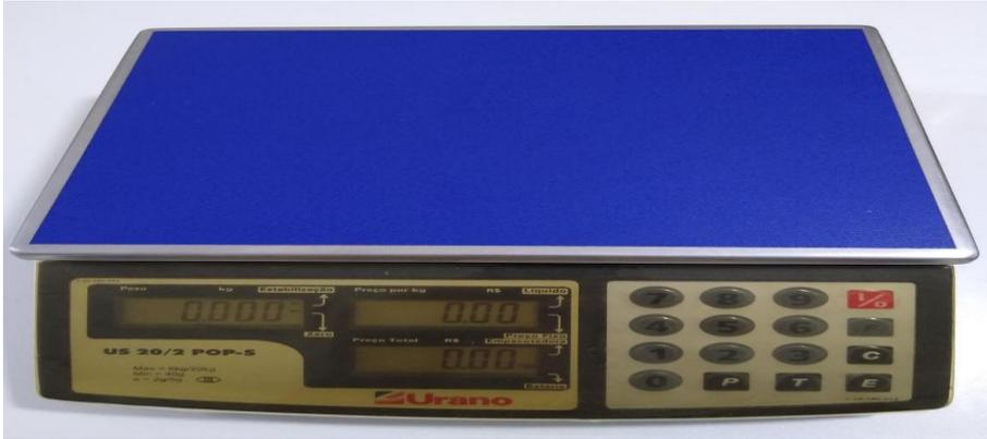
Figura 36: Balança de precisão utilizada para pesar a massa da amostra dos resíduos em quilos.
