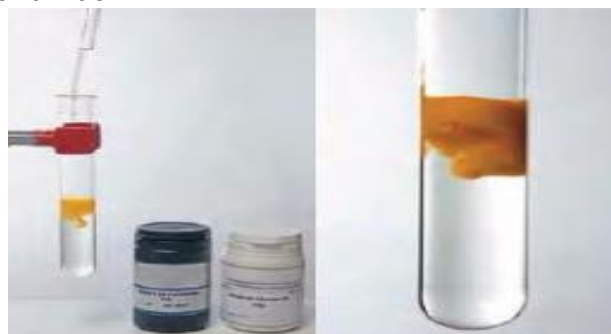
Figura 24 – Experimento indicativo da formação do precipitado de iodeto de chumbo II, na presença dos íons K^+ e I^- do iodeto de potássio e íons de Pb^{2+} e NO_3^- do nitrato de chumbo II.
