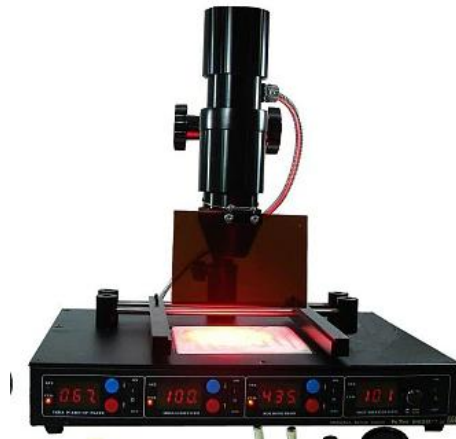
Figura 7 - Estação de solda simples com aquecedor inferior
