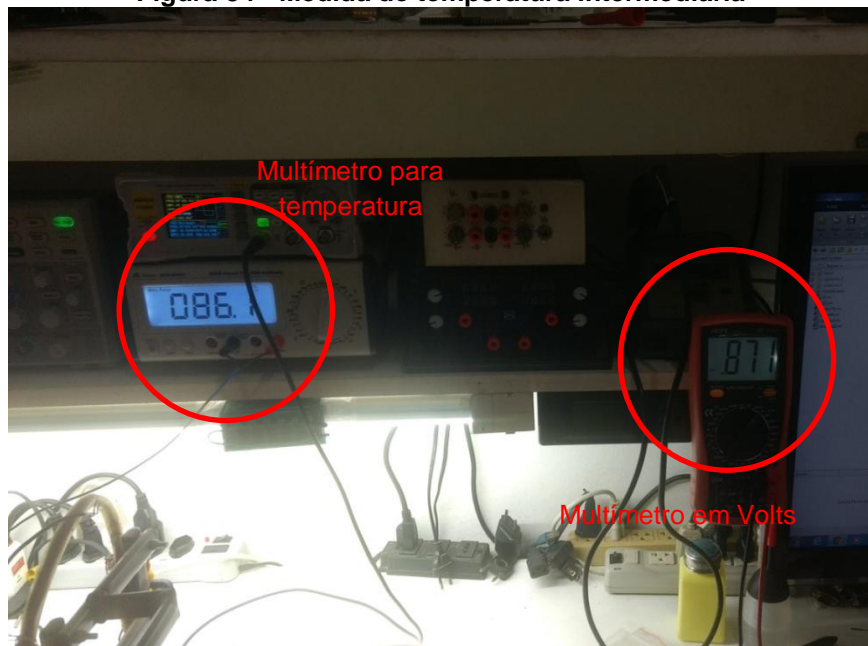
Figura 34 - Medida de temperatura intermediária
