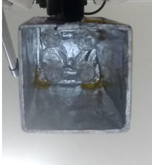
Figura 20 - Tubo quadrado para alojamento de lâmpadas
