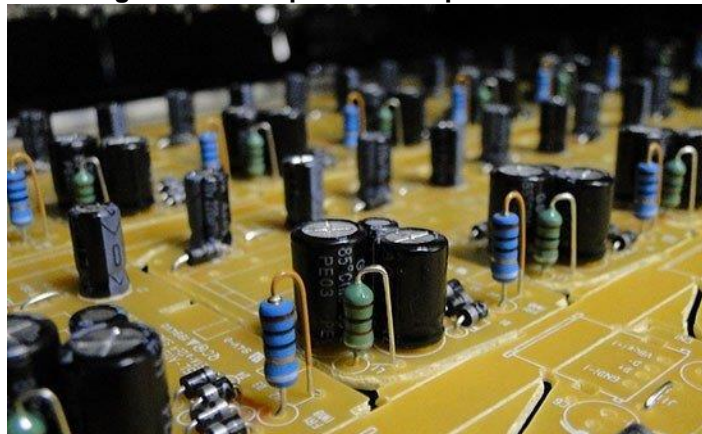
Figura 1 - Exemplos de componentes PTH
