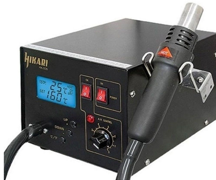
Figura 4 - Estação de ar
