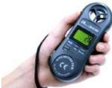
Figura 11 - Anemômetro digital de bolso
