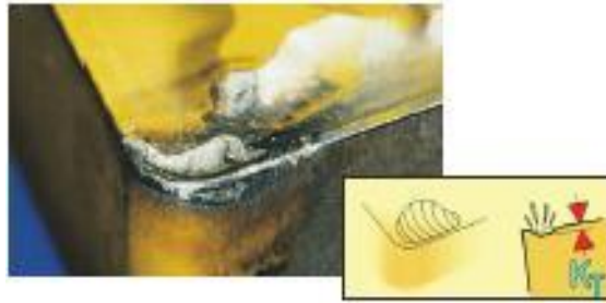
Figura 10 - Desgaste de cratera
