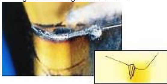
Figura 11 - Desgaste de entalhe
