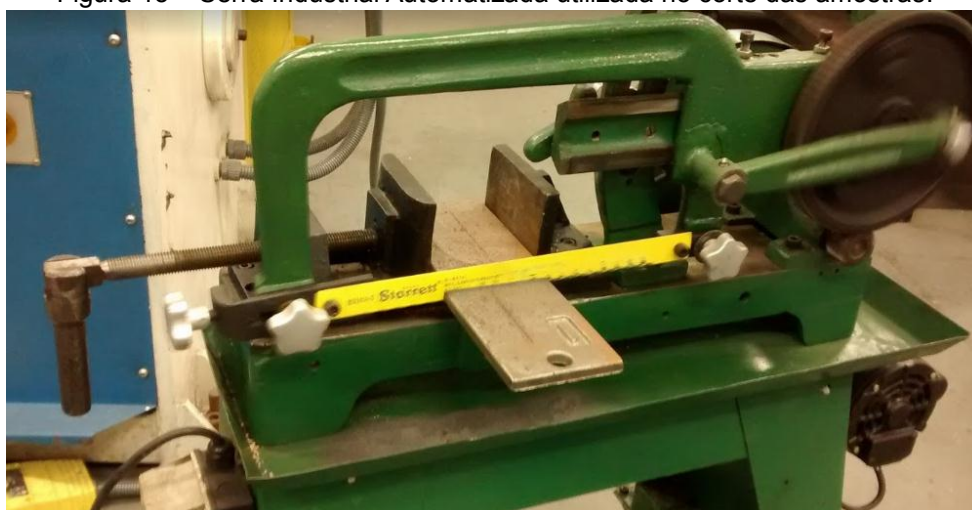
Figura 15 – Serra Industrial Automatizada utilizada no corte das amostras.
