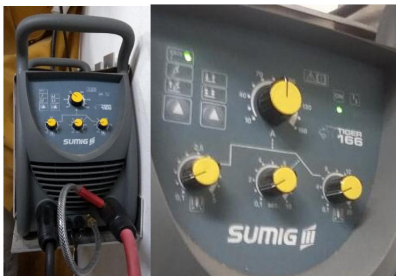
Figura 21 - Máquina inversora portátil, para soldar com eletrodos revestidos e TIG Sumig Tiger 166/ Tensão de 220V / Corrente de 5 a 160 A.
