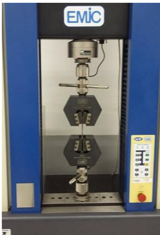
Figura 23 - Máquina de ensaios universal DL10000/ Capacidade 10000 kgf/ Faixa de abertura (sem garras): de 120 A 1370 mm / Largura útil entre as colunas: 400 mm.
