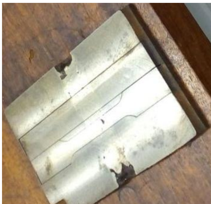
Figura 27 - Área de retirada de corpos de prova para ensaio de tração e flexão.
