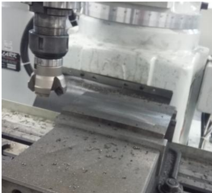
Figura 18 - Faceamento dos corpos de prova.
