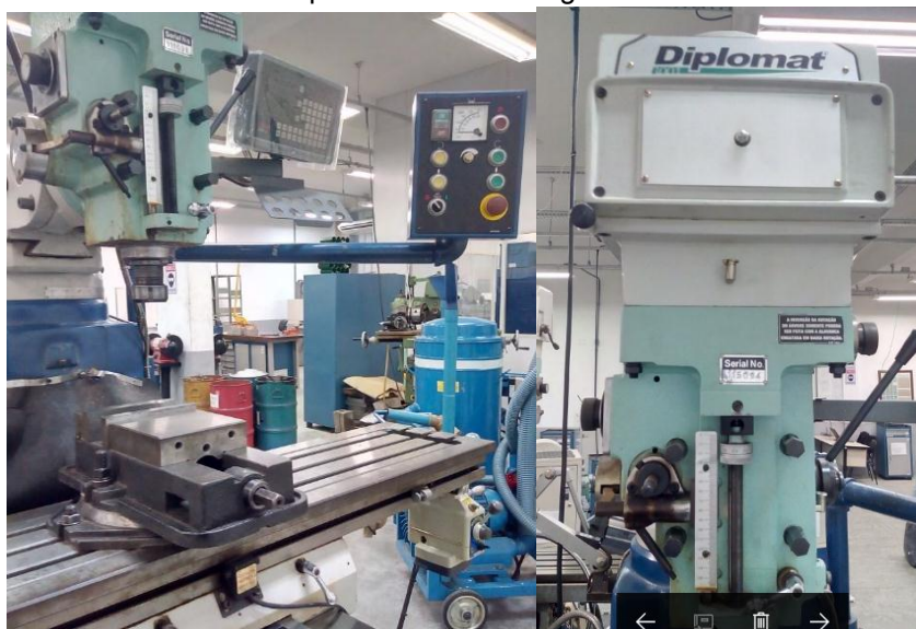
Figura 17 - Fresadora Ferramenteira Diplomat / 3 Eixos / Painel Digital de coordenadas utilizada nos processos de usinagem.
