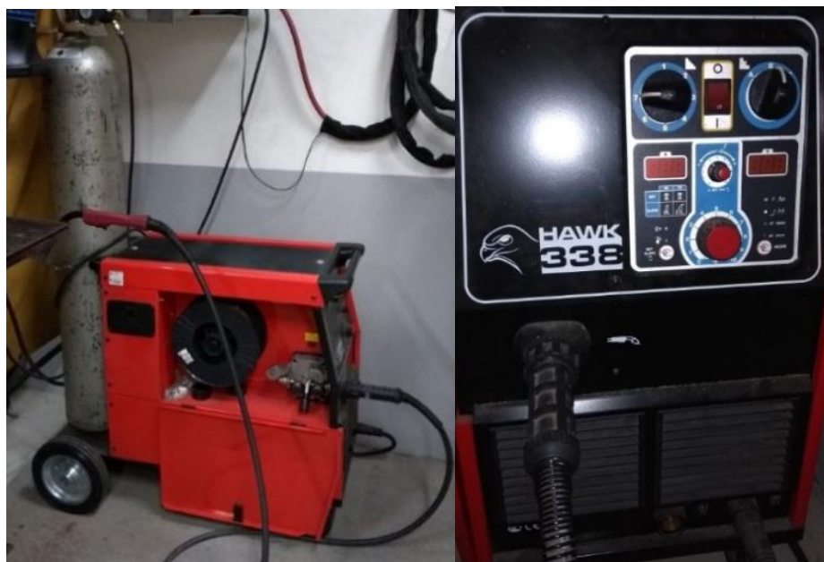
Figura 22 - Máquina de Solda MIG/MAG Hawk 338 – Corrente de regulação 30 a 300 A/ Diâmetro do arame 0,6 / 1,2 mm.
