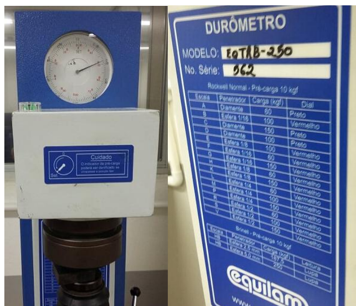
Figura 24 - Durômetro de bancada modelo EQTRB-250 fabricante EQUILAN.
