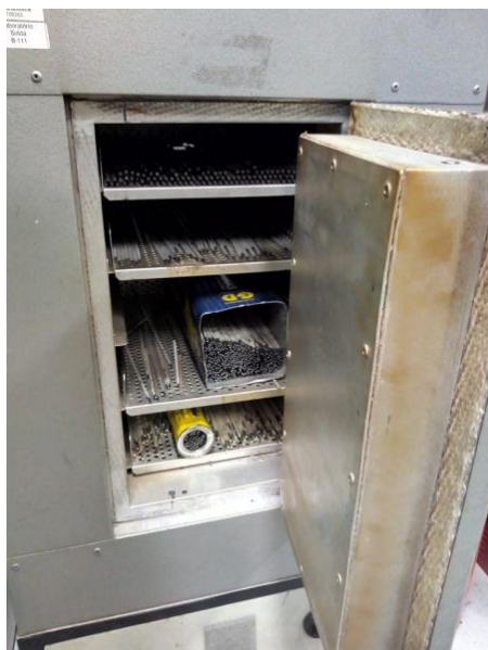
Figura 25 - Forno com controle de Temperatura e umidade para armazenamento de eletrodos.
