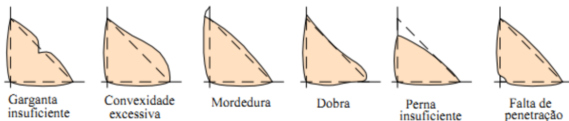
Figura 11 - Exemplos de perfis inadequados.
