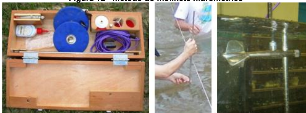
Figura 12 - método do molinete hidrométrico
