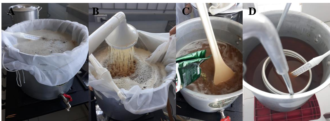
Figura 3 - Processo de produção de cerveja APA, panela juntamente com os maltes e água mineral acondicionados em um tecido e termômetro para controle da temperatura (A), chuveiro para realizar recirculação da cerveja na panela (B), adição dos lúpulos nos diferentes tempos de fervura (C) e resfriamento rápido com auxílio de um chiller de alumínio (D).
