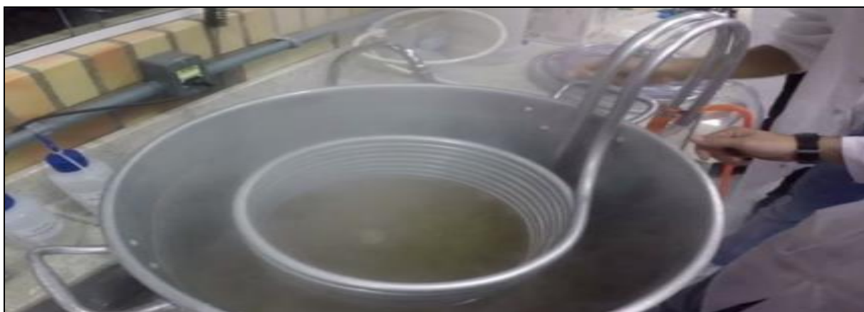
Figura 16: Chiller de imersão resfriando o mosto
