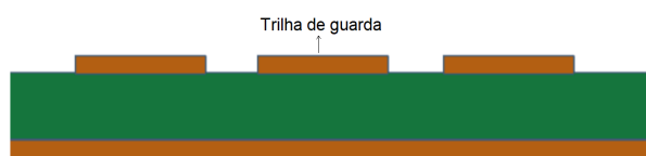
Figura 19 – Trilha de guarda em PCI
