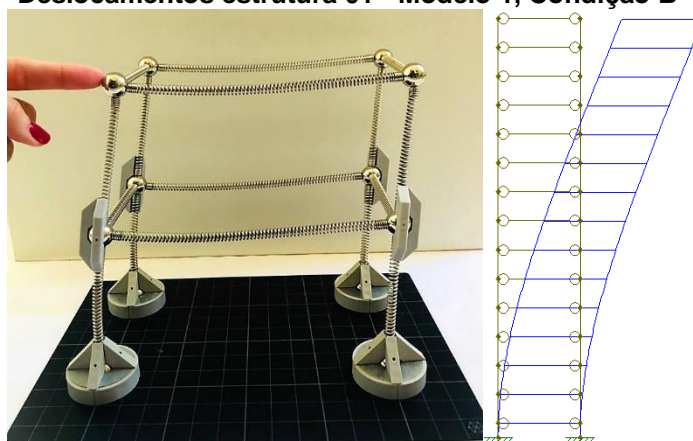
Figura 81 – Deslocamentos estrutura 01 - Modelo 1, Condição B
