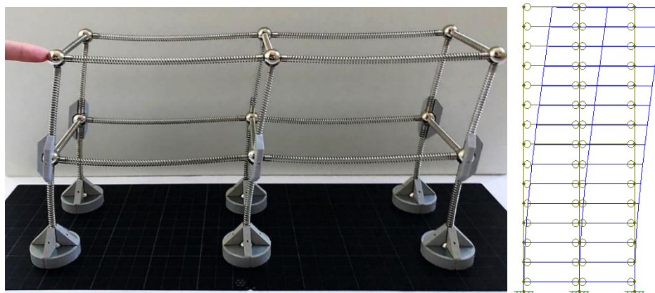
Figura 97 – Deslocamentos estrutura 02 - Modelo 1, Condição B
