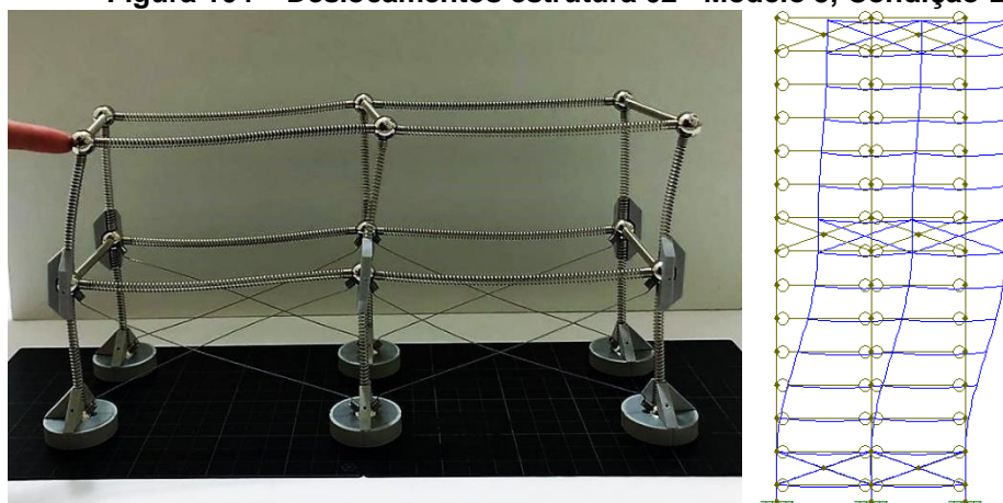
Figura 104 – Deslocamentos estrutura 02 - Modelo 3, Condição B
