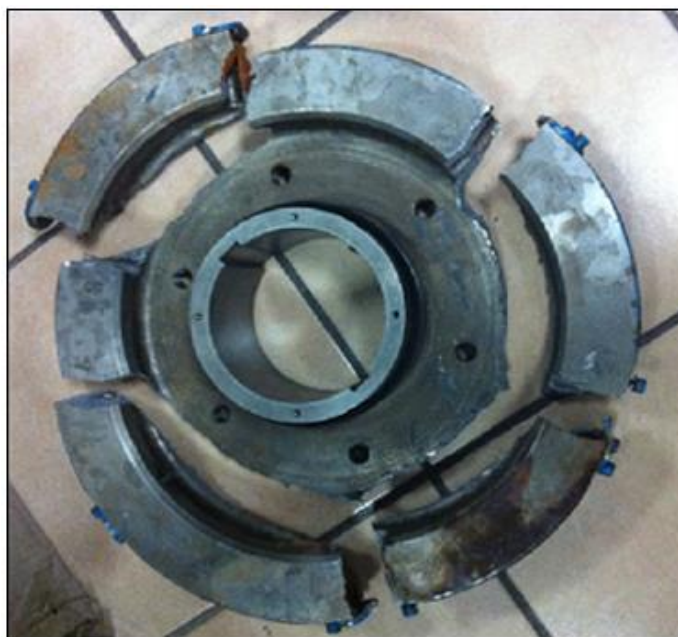
. Figura 13 – Disco quebrado
