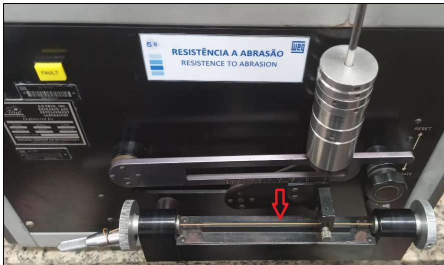
Figura 13 - Equipamento abrasão com amostra fixada para o ensaio
