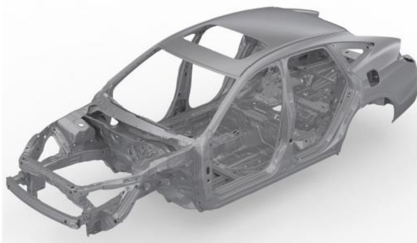
Figura 12 - Chassi monobloco de um carro popular
