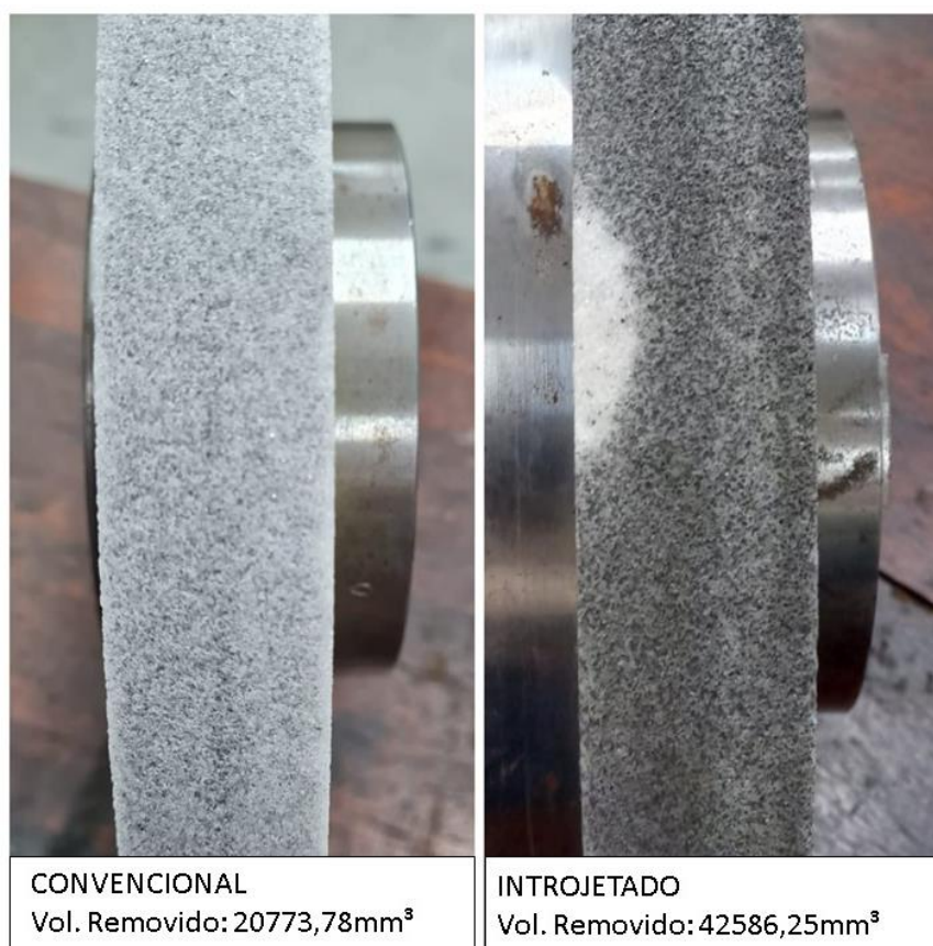
Figura 20: Superfície de corte do rebolo ao final dos ensaios.
