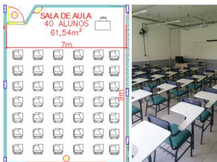
Figura 10 — Planta baixa e disposição de materiais de uma sala de aula.
