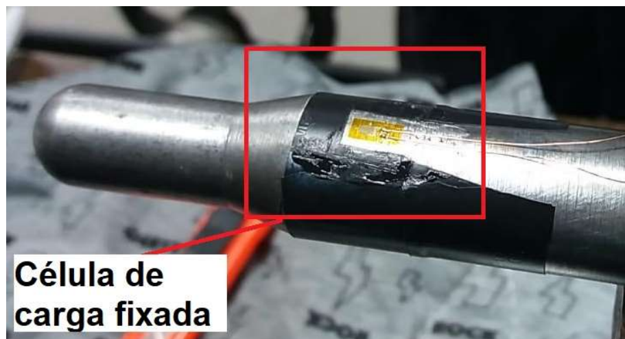
Figura 16 – Forma de fixação da célula de carga na ferramenta.
