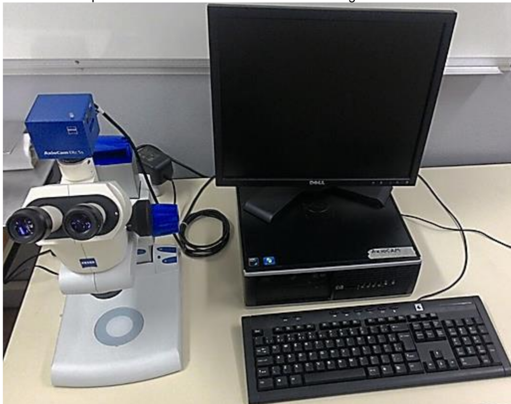
Figura 6 - Estereoscópio utilizado na análise de defeitos de usinagem
