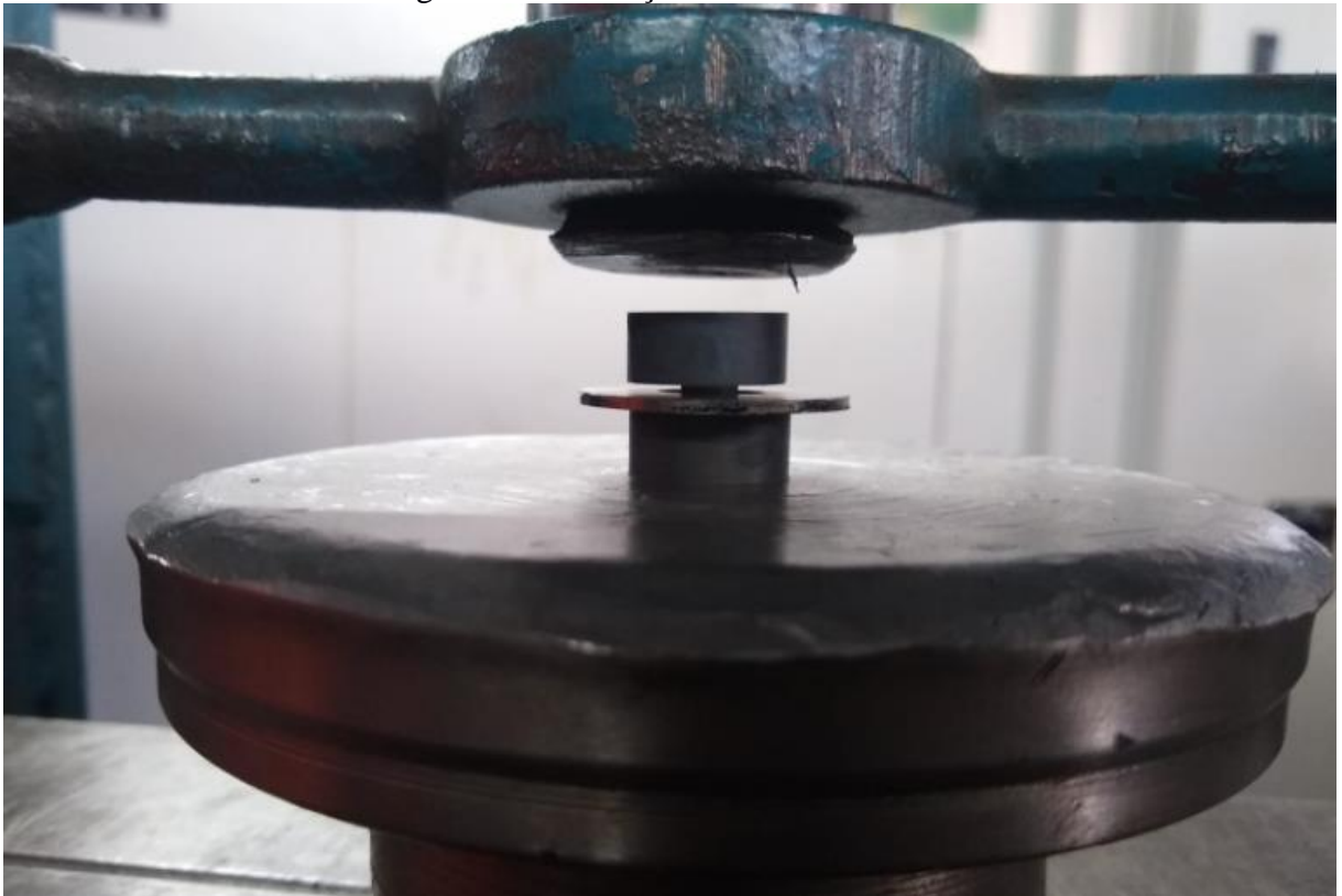
Figura 18 - Execução do ensaio do anel.
