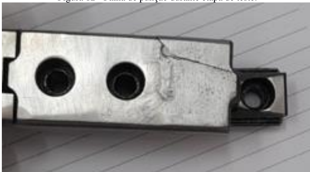
Figura 12 - Falha de punção durante etapa de teste.
