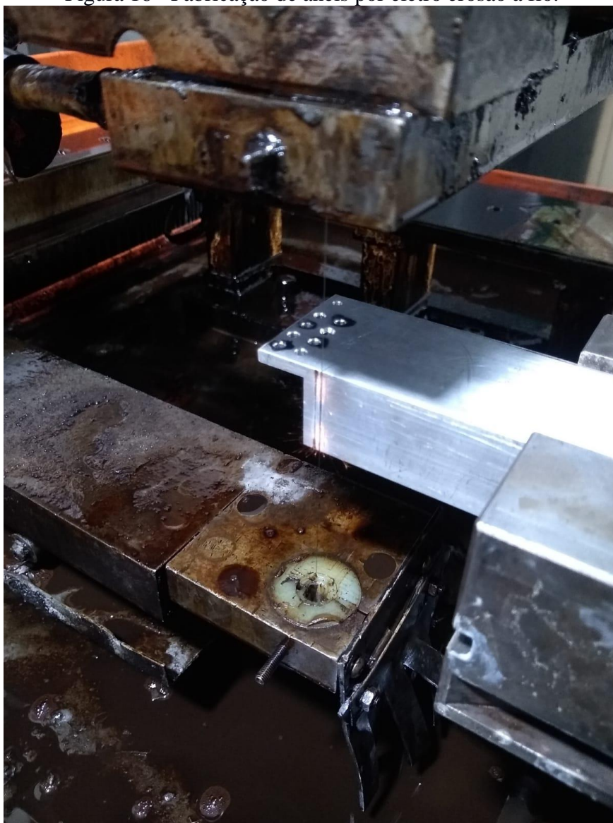
Figura 16 - Fabricação de anéis por eletro erosão a fio.
