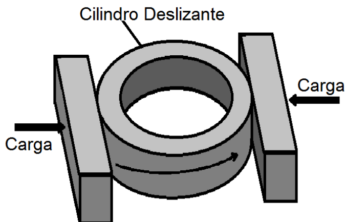
Figura 5 - Ensaio de planos retangulares sobre cilindro rotativo
