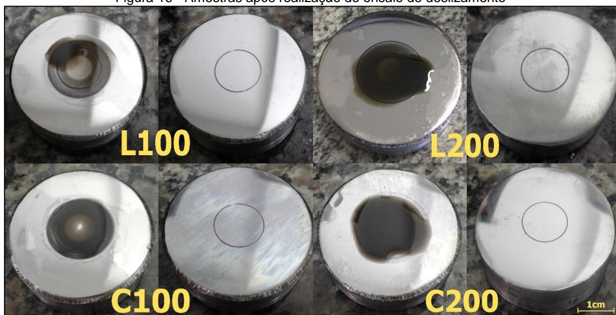
Figura 16 - Amostras após realização do ensaio de deslizamento
