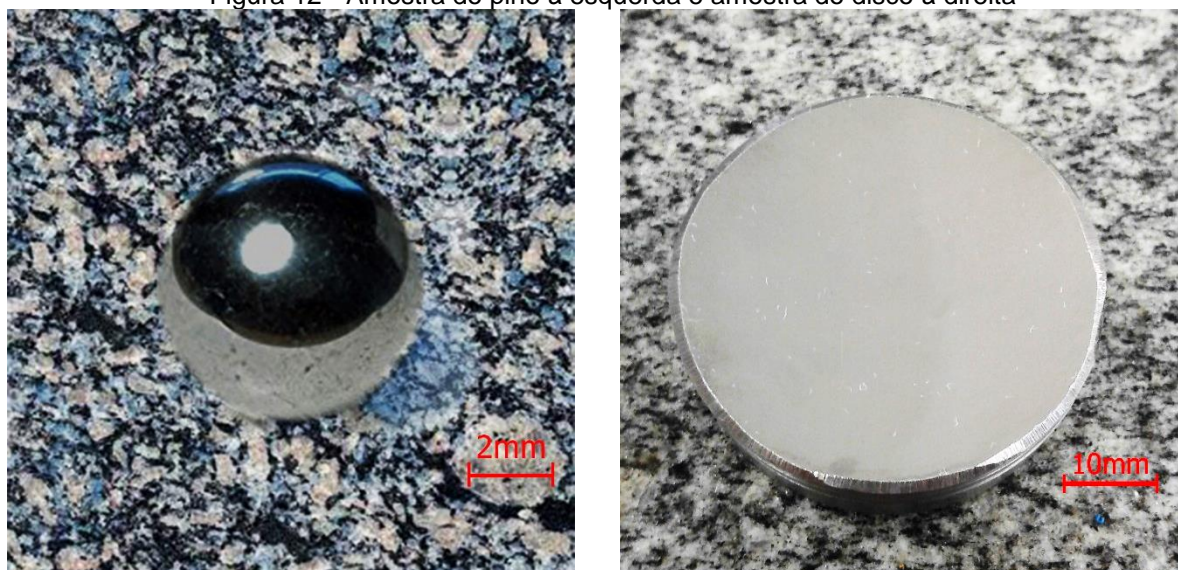
Figura 12 - Amostra do pino à esquerda e amostra do disco à direita
